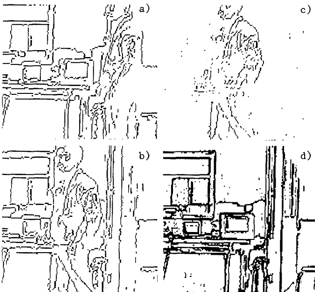
Fig.3. Contours binaires détectés en temps réel : a) image précédente, b) image courante, c) objet en mouvement, d) image historique.
