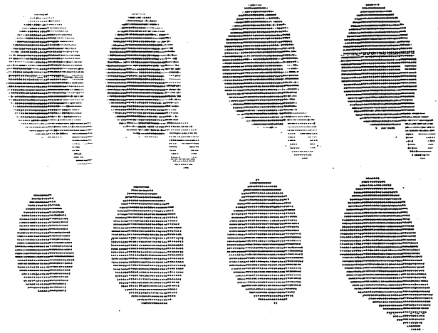
Figure 6 : Illustration du modèle de croissance région avec contrôle de convexité. La première ligne représente l'évolution de la région et la seconde ligne l'enveloppe convexe associée. La rupture est constatée à la dernière étape par éclatement de l'enveloppe convexe.
