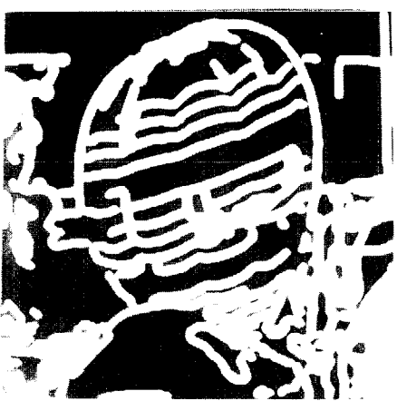
Photo 2 - Contours obtenus par la méthode de Deriche ( Image de départ en niveau de gris )
