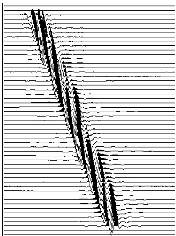
Figure 2 : Données initiales réelles après prétraitement. L'axe horizontal correspond à l'axe temporel de 0 à 512 ms L'axe vertical correspond à l'axe spatial de 11 à 100 mètres. Le point (0,0) se trouve en haut et à gauche. Les données sont représentées en normalisation trace à trace.
