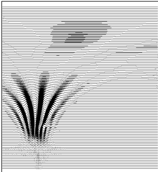
Figure 6 : Analyse multi-échelle de la trace 3. L'axe vertical est celui des échelles (fréquences). L'axe horizontal est celui des temps.
