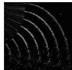
FIG. 3 : exemple d'image multiexposition : 7 expositions successives d'un même jet
