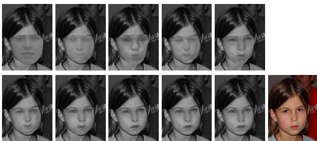
FIG. 2 – Adaptation itérative du modèle, en partant d'une pose et d'une apparence proche du visage cible situé en bas à droite.
