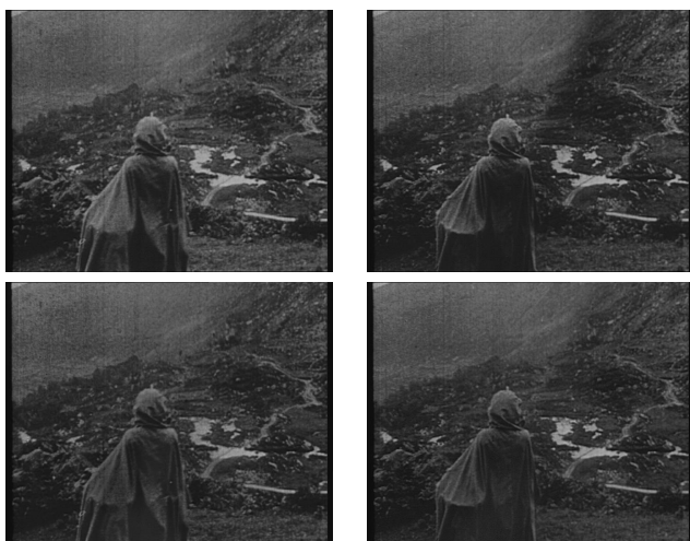
FIG. 4 – Images extraites de Rory O'More . En haut les images originales dégradées par un flicker particulièrement localisé. En bas les images restaurées.
