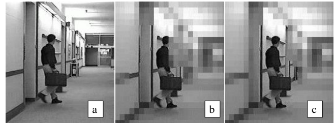
FIG. 2 : Amélioration de la détection de cible : a) image en pleine résolution ; b) résultats précédents de détection à partir d'image sous résolues [7] ; c) réduction de la distorsion de l'image avec notre nouvelle solution.
