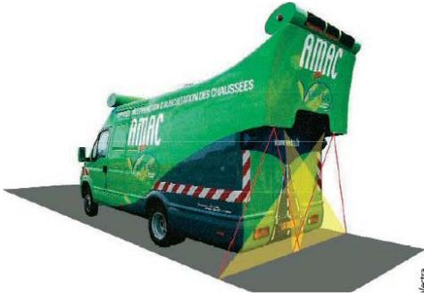
FIG. 1 : Dispositif d’acquisition d’images de surface de chaussées.
