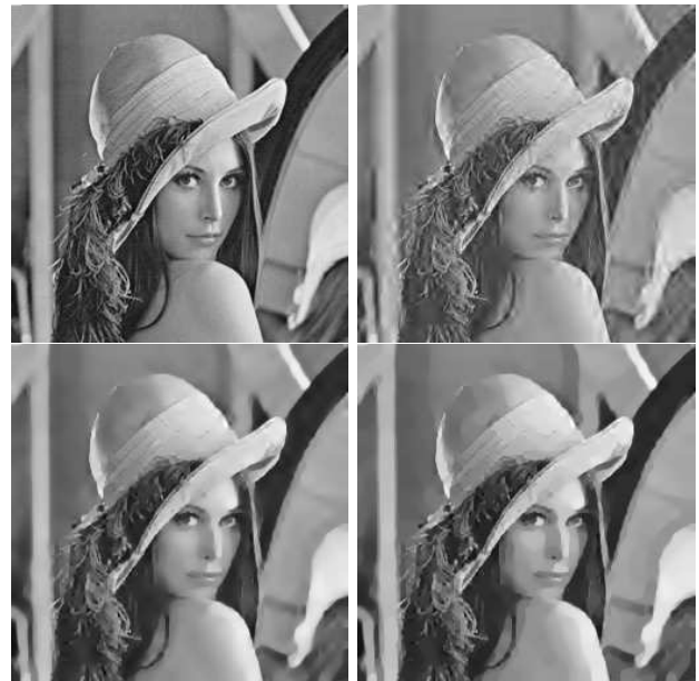
FIG. 2 – Reconstruction d'une image après quantification des coefficients d'ondelettes Daubechies 9-7. HG : original - HD : compressée - BG : Décompressée avec \mu = 0.01 - BD : Décompressée avec \mu = 0.0001
