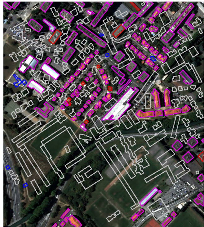
FIG. 3 – Résultats de la vérification de la BD bâtiments.
