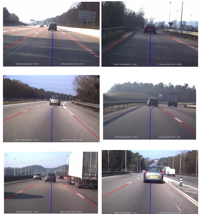
FIGURE 2 – Détection des lignes de marquages par temps sec
