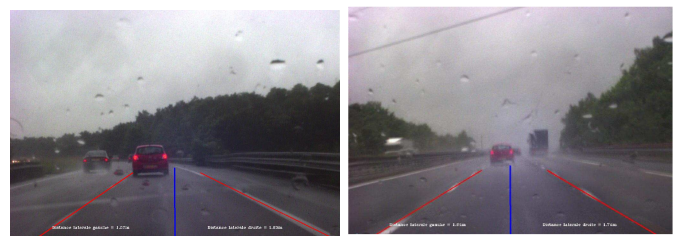
FIGURE 3 – Détection des lignes de marquages par temps pluvieux
