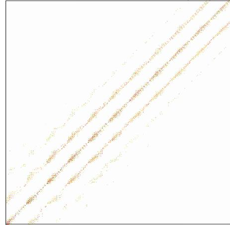
FIG. 4 – Matrice d'intercorrélation des spectres seuillée à 0,995. La structure en bandes de cette matrice est liée à l'échantillonnage des paramètres.
