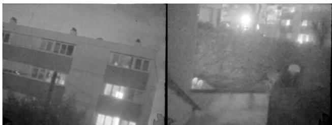
FIG 10. exemple d'images d'une caméra MAGIC intensifiée. La très grande dynamique de MAGIC permet d'observer simultanément les zones très contrastées (l'intérieure des fenêtres éclairées, le fond de jardin avec la présence de forte lumière d'éclairage).
