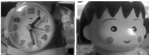
FIG 8. Des images à la sortie d'un capteur MAGIC 384x288-pixel fabriqué en AMS 0.35um. Il faut noter que ces images sont codées sur 7 bits seulement malgré de forts contrastes créés par les reflets.
