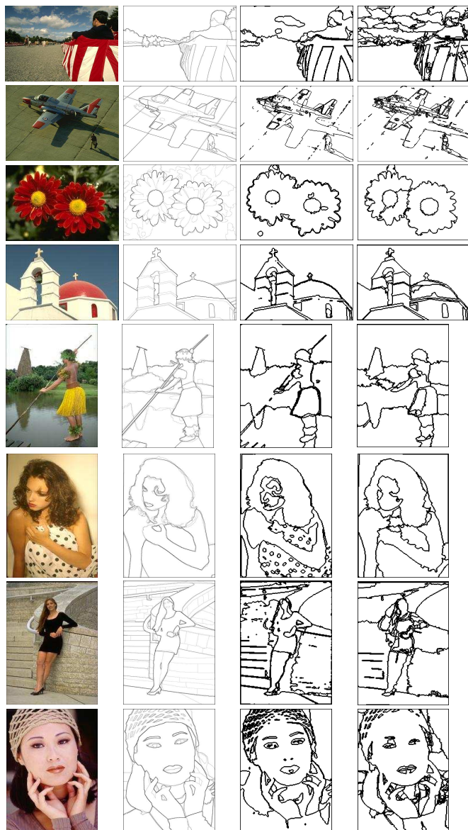
Figure 4 : Segmentation obtenues sur des images issues de la base d'images Berkeley. De gauche vers la droite : images originales, images segmentées par l'Humain, par notre approche et par l'algorithme Mean Shift .
