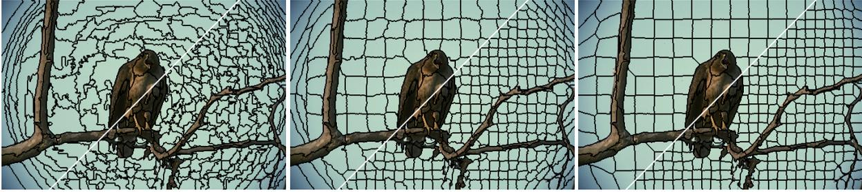
Figure 1: Image *Aigle* avec 150 (coins supérieur gauche) et 600 (coins inférieur droit) superpixels (Nombre de superpixels pour l'image entière). De gauche à droite, variation du facteur de compacité :  $m = 0$ ,  $m = 1$ , et  $m = 20$ .
