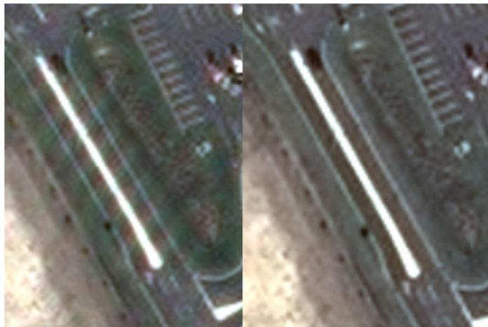
Figure 6 Différence entre ancienne (gauche) et nouvelle (droite) chaîne de fusion
