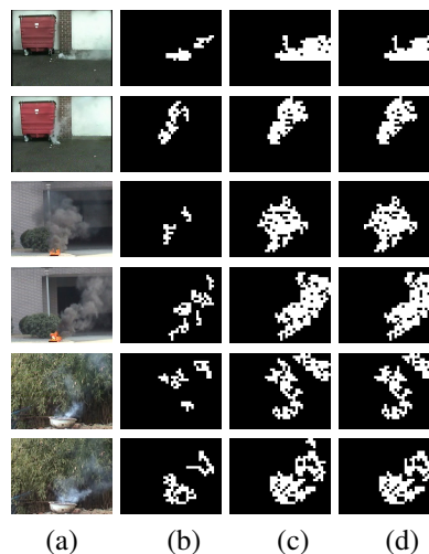
FIGURE 5 – (a) Images testées des séquences sWasteBasket, Black_smoke_517 et Dry_leaf_smoke_02. (b) Détection par la méthode de Yuan. (c) et (d) Détection par la méthode proposée utilisant respectivement BGC3 et CS-LTP.
