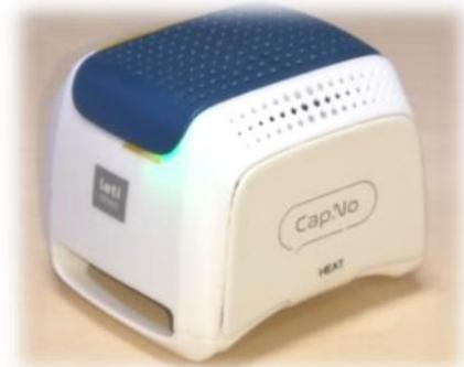
**Figure 1** : Le dispositif portable autonome CAPNO pour la mesure sur le bras du gaz carbonique sanguin émis par la peau. Le dispositif comprend également dans chaque cellule des capteurs de température, de pression et d'humidité utilisés pour le calcul de la pression transcutanée  $P_{tc}CO_2$ .
