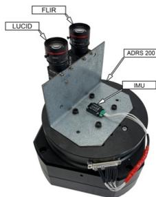
Figure 8 : Plateforme de démonstration.
