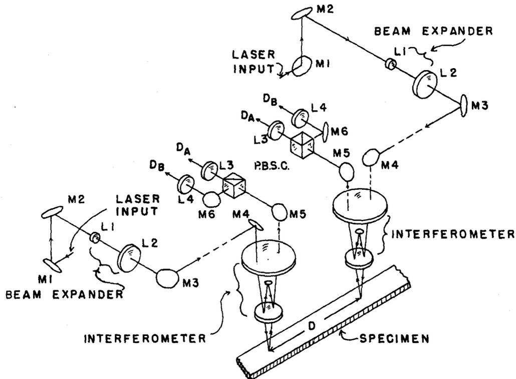
Fig. 2. - Dual laser interferometer (Fizeau).
