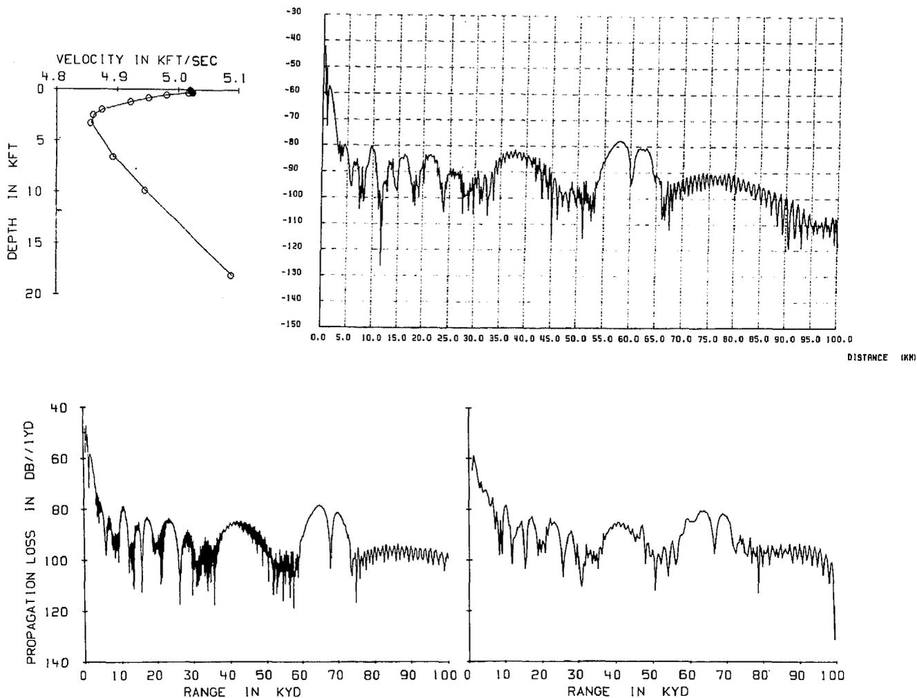
Fig. 2. — Exemple de calcul modal utilisant la méthode des différences fines (en haut à droite) pour la bathycélérimétrie reportée à gauche. Les courbes du bas ont été tirées de [2] et correspondant à un calcul par rayons généralisés (à gauche) et par transformée numérique de la fonction de Green (à droite).
