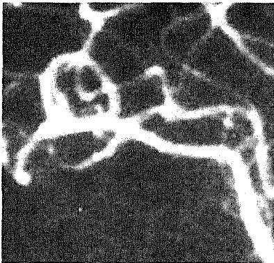
Fig. 28. — Image figure 28 filtrée par un FILTRE MEDIAN 3 x 3 ⇒ diminution du bruit impulsif.
