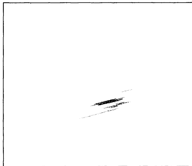
Figure 15. — Image segmentée avec une matrice de co-occurrence optimisée ( dx = 9 , dy = -15 ).
