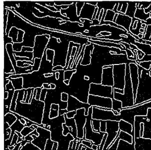
Figure 29. – Contours détectés après filtrage de Canny-Derichet et suppression des non-maxima locaux
