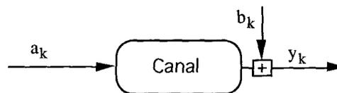
Figure 2. – Schéma équivalent de communication en bande de base.
