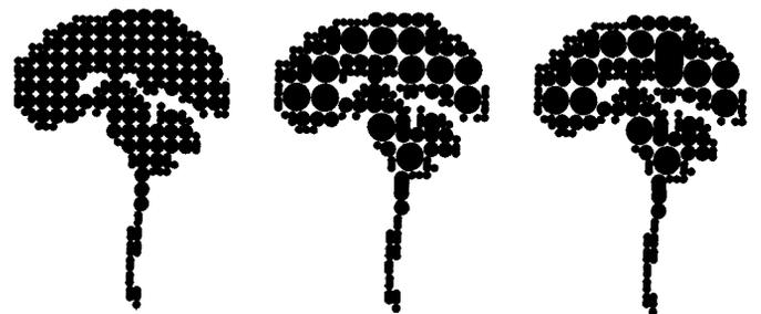
Figure 19. – Rééchantillonnage de type kd-tree de la figure 16. De gauche à droite, nous avons considéré des blocs de  $2 \times 2 \times 2$ ,  $4 \times 4 \times 4$  et  $8 \times 8 \times 8$  pixels, et obtenu respectivement 165, 121 et 120 points.
