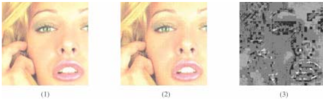
Figure 6. Delta E CIE-94: (1): image originale, (2) image perturbée par un signal masqué tel que \Delta E = 3 . (3) Image \Delta E obtenue ( \Delta E \leq 2 : noir, \Delta E = 3 : gris foncé, \Delta E = 4 : gris clair et \Delta E > 4 : blanc).
