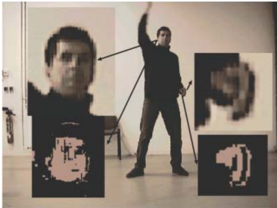
Figure 9. Illustration de la robustesse de l'extracteur de peau pour des conditions d'éclairage défavorables.
