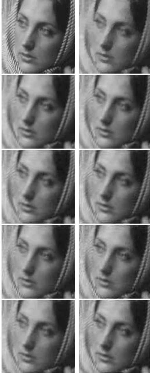
Figure 1. Résultats sur l'image Barbara, image observée (PSNR = 25,90 dB). Seuls sont présentés les résultats avec les transformations classiques (TV, DTCW, RDWT et Curvelets) et un résultat obtenu par dictionnaire (Curvelets + RDWT). (P) désigne un a priori de parcimonie tandis que (R) désigne un a priori de régularité. De gauche à droite et de haut en bas : image d'origine, résultat obtenu avec la TV, DTCW (R), DTCW (P), Curvelets (R), Curvelets (P), RDWT (R), RDWT (P), Curvelets + RDWT (R) et Curvelets + RDWT (P)
