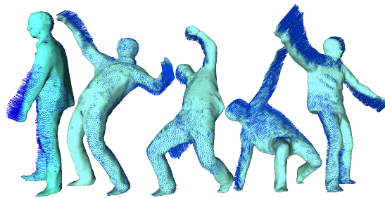
Figure 1. Exemple de flot de scène dense calculé à partir de correspondances de points d'intérêt 2D et 3D et de flot de normal dense
