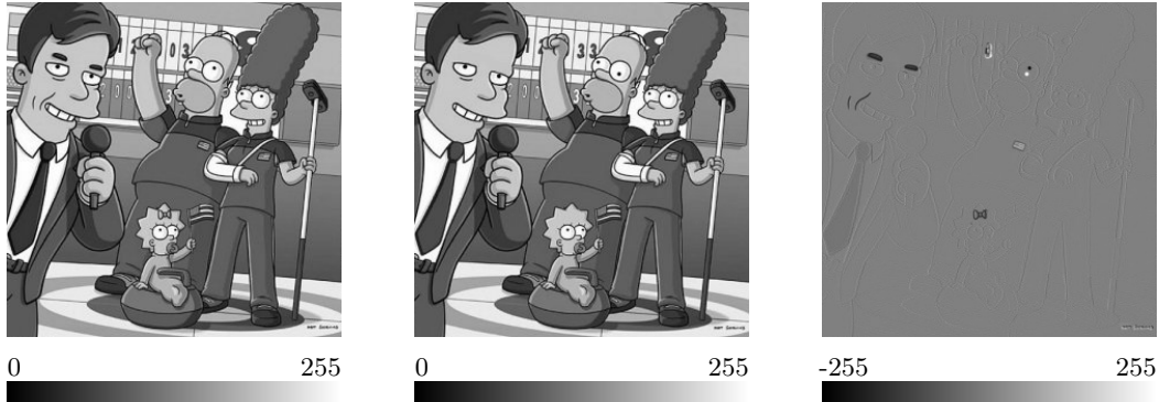
FIGURE 4 – L'image de droite est la différence des deux images de gauche. Notez que l'image de différence a des valeurs entre -255 et 255 .
