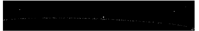
(b) Seuillage simple à 75 : des pixels de l'atmosphère sont détectés et génèrent 184 régions.
