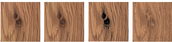
FIGURE 2 : Image originale (gauche), reconstruction par AE (centre gauche), reconstruction par AE discretisé (centre droit) et restauration par AE discretisé (droite)
